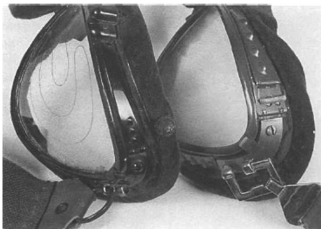
Слева: крупный план очков с электроподогревом, отличающихся тонкими проволочками, проложенными между двойными линзами, и рельефной эмблемой фирмы MAN на алюминиевой оправе. Заметен остаток электрического кабеля. Справа: экспериментальные незапотевающие очки со специфической G-образной пружинкой.
